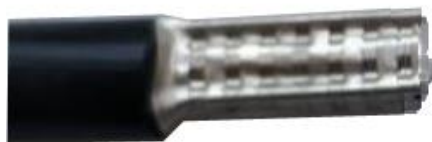
Рисунок 6.1 – Обжим провода СИП наконечником НШВ 16-18
