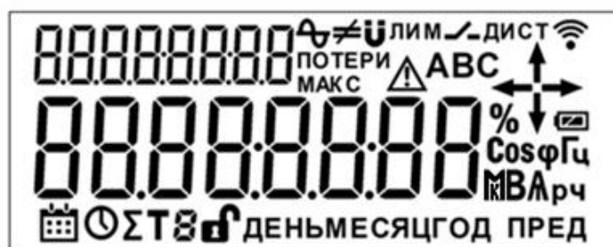
Рисунок 6.3 – Внешний вид ЖКИ
