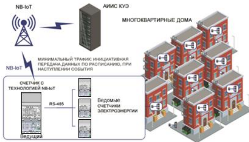
Рисунок 5.3 – Схема работы счетчика NB-IoT в составе АИИС КУЭ
