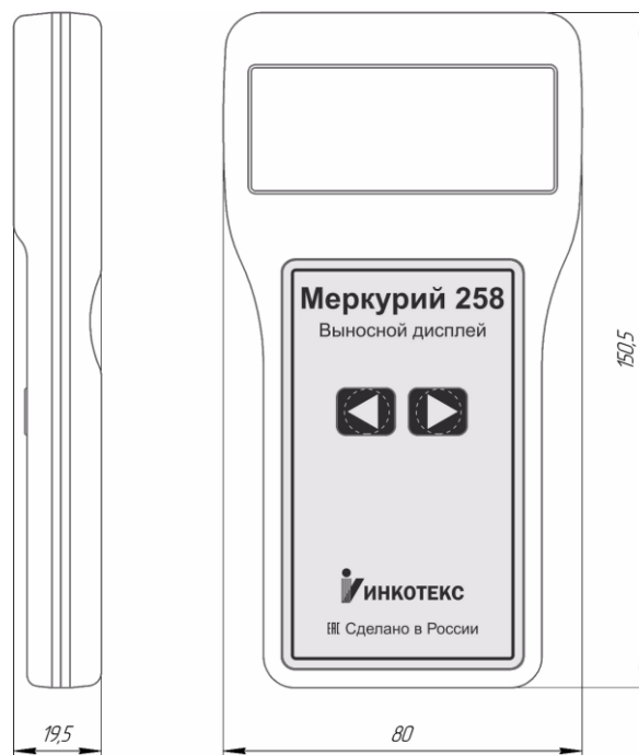
Рисунок А.3 – Габаритный чертеж выносного дисплея
