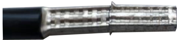
Рисунок 6.1 – Обжим провода СИП наконечниками НШВ 16-18
