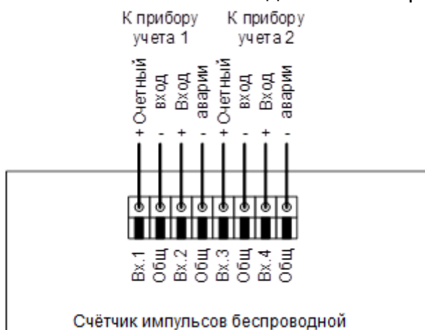
Рисунок 5 - Пример подключения приборов учета ресурсов к счетчику.
