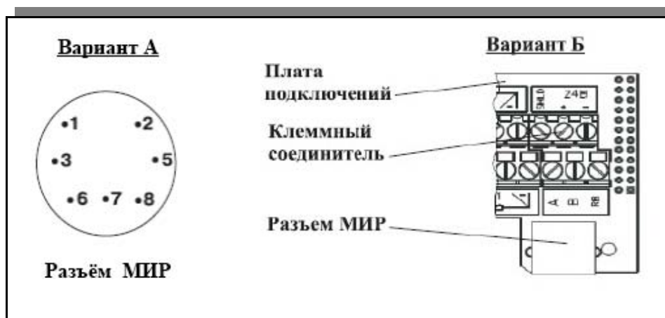
Рисунок 1.3 – Варианты подключения вычислителя к интерфейсам RS-485 и M-Bus
